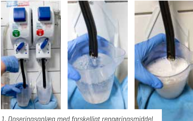
1. Doseringsanlæg med forskelligt rengøringsmiddel
